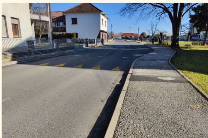
Slika 34: Grbina za umirjanje prometa v ulici Juša Kramarja v Črenšovcih v bližini osnovne šole Franceta Prešerna Črenšovci s smeri državne ceste R2-443/0369 Črenšovci
